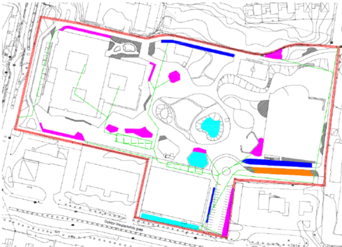
Figur 10. Kartan visar fördörjningsförslag inom det rödmarkerade planområdet. Ytor där det föreslås fördörjning i växtbäddar/biofilter är magentamarkerade. Ytor där skelettjord föreslås för fördörjning är mörkblåmarkerade. En makadamfördörjning under gräsarmering är ritat i orange samt översvämningssytor i cyan. Föreslagna dagvattenledningar att koppla ihop fördörjningar och leda dagvatten till befintliga anslutningspunkter är grönmarkerade.
